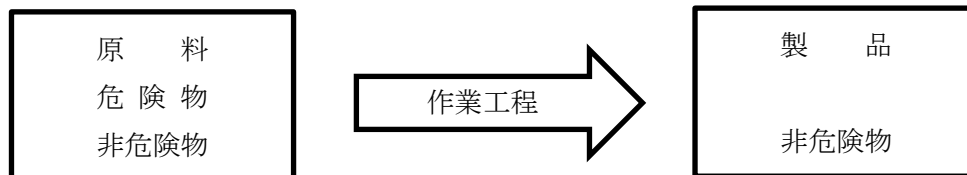
図 3-16 一般取扱所の製造工程の例
